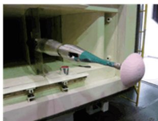
はやぶさカプセル・柔軟構造エアロゲルの試験用模型
