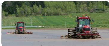
田植え前の大事な準備作業「代かき」 2台のトラクターが衛星「みちびき」と通信しながら 協調・連携して作業を行っています (写真提供：北海道大学)
