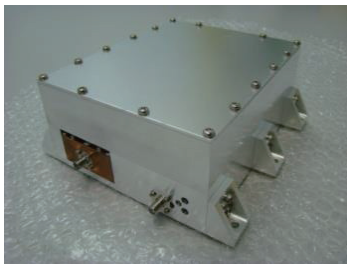
図1 探査機の増幅器 (川崎研開発)
