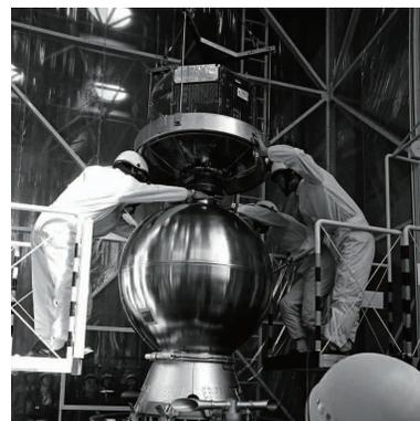
CORSA-b、上段モータへ組付け
