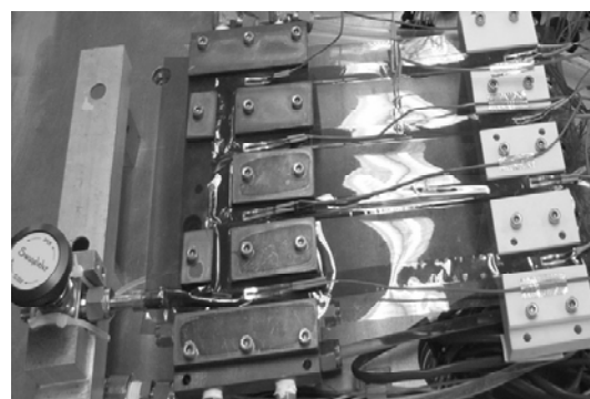
Fig. 3 ヒートパイプ伝熱評価装置 (右側が高温側ヒータ部、左側が銅水冷部)
