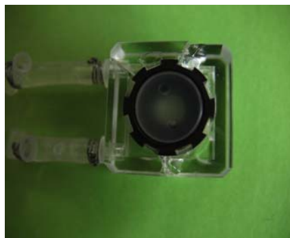
図3 割れた石英セル
