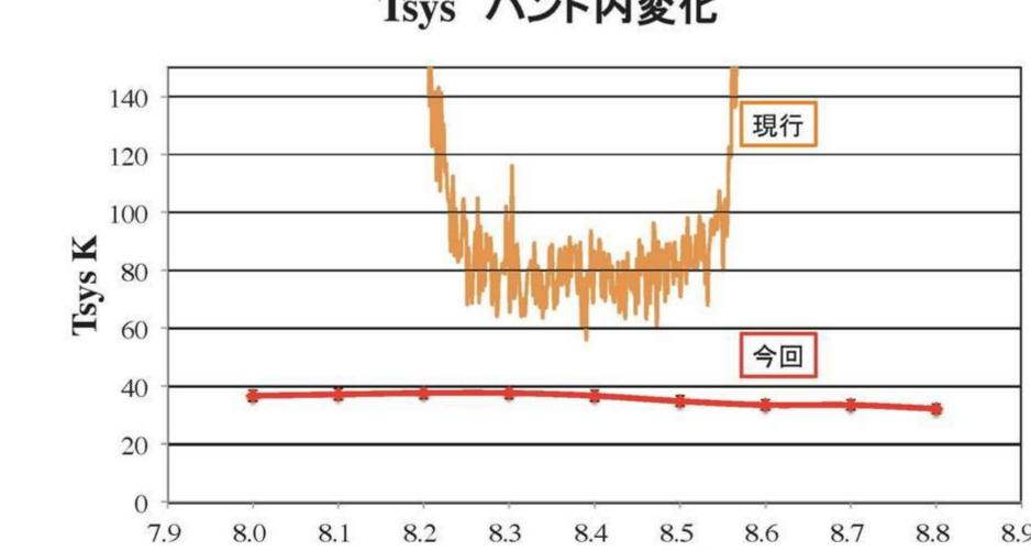
Frequency GHz これにより探査機でもの受信専用の運用でも3dB以上の改善は可能 まとめ
