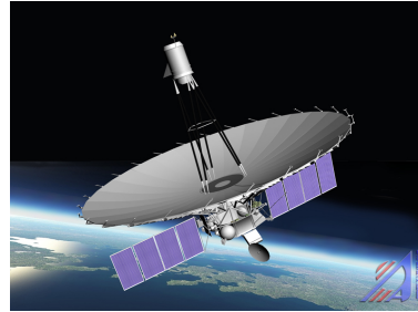
図1: 軌道上の「Spektr-R」衛星の想像図。直径10mのパラボラアンテナを天体電波望遠鏡として用い、観測波長92cm, 18cm, 6cm, 1.3cmのフィードおよび受信機がパラボラの一次焦点に設置されている。
