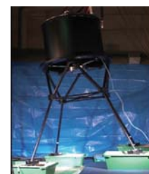
図4 実機モデル落下試験の全景。
