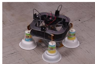
保持解放機構・重力補償装置を用いたブーム・膜展開試験
