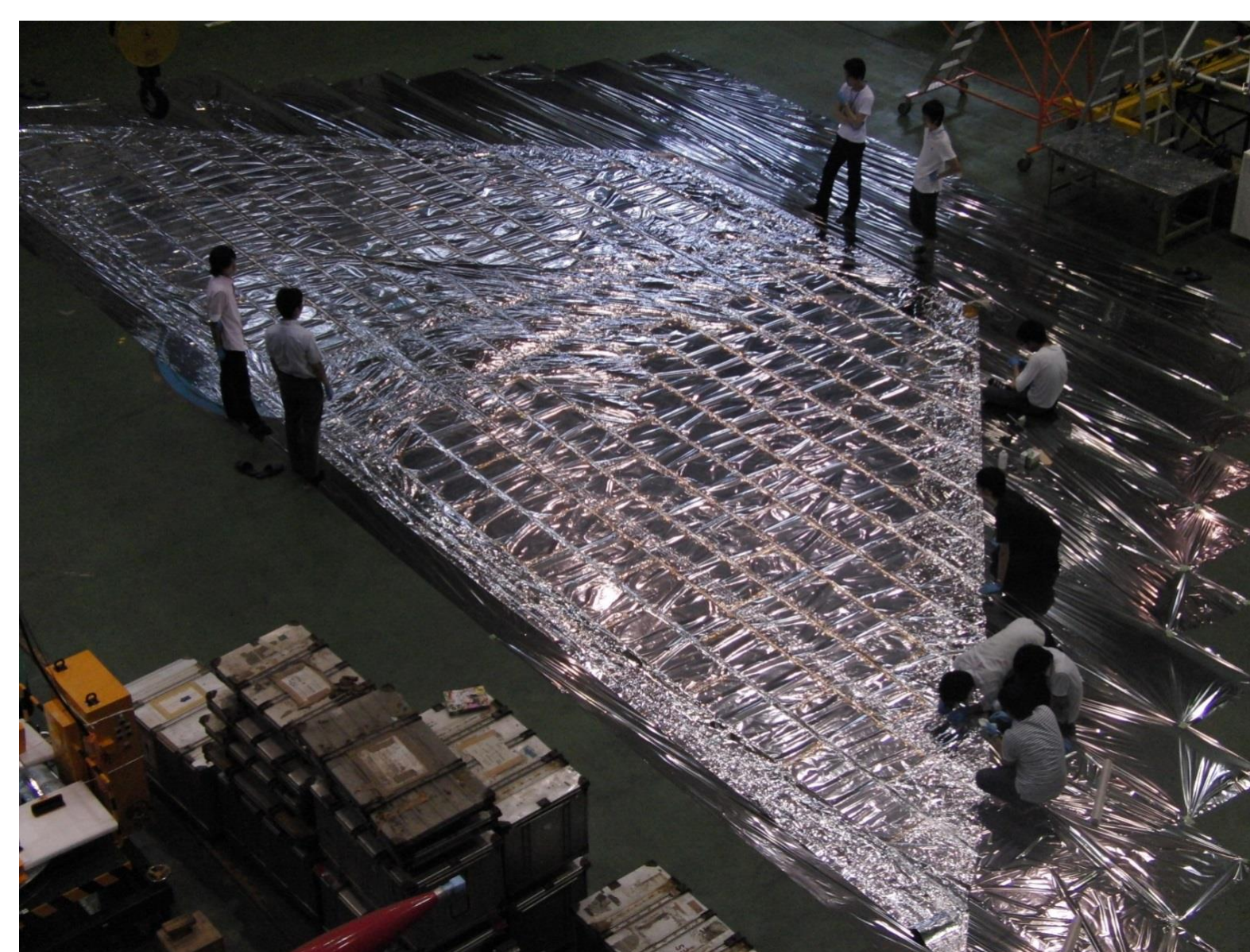
図5 試作セイル外観 一辺は18mである。 写真にある台形形状のセイルを4枚組み合わせて、正方形セイルを構成する。
