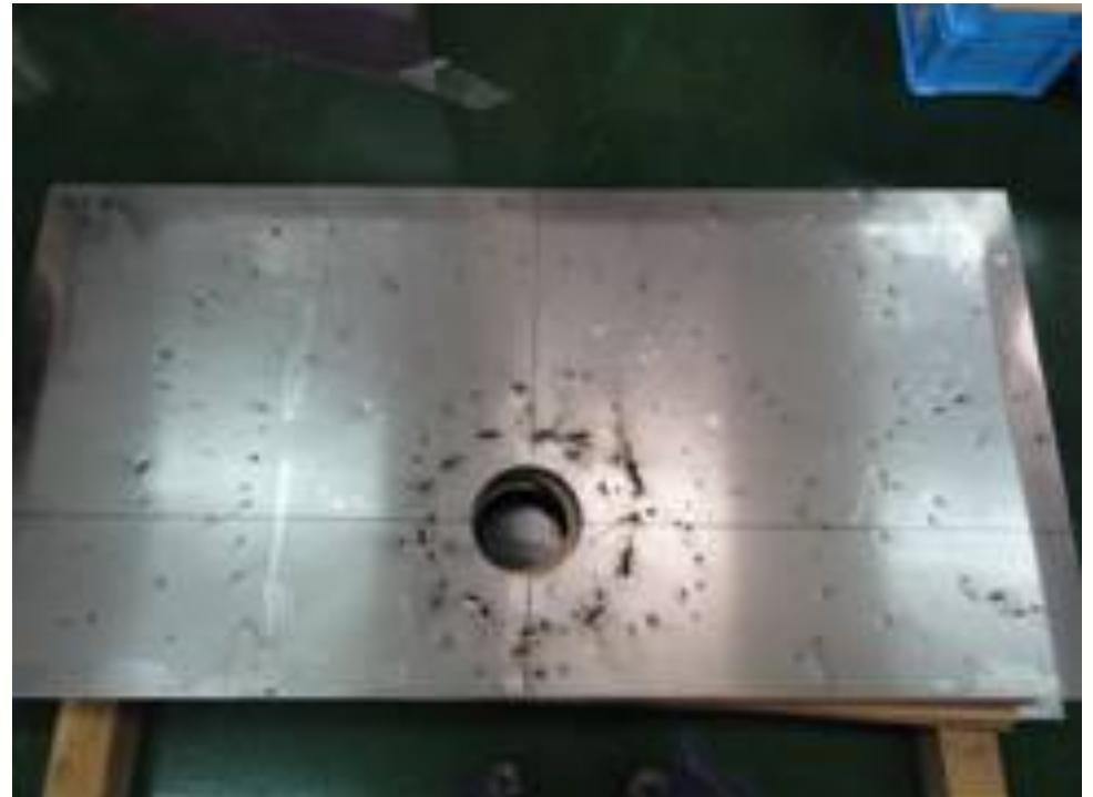
1/2スケール SCI 試験： インパクタ以外の破片空間分布・
