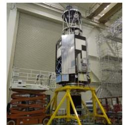
図3 HXIプレート分離衝撃試験セットアップ
