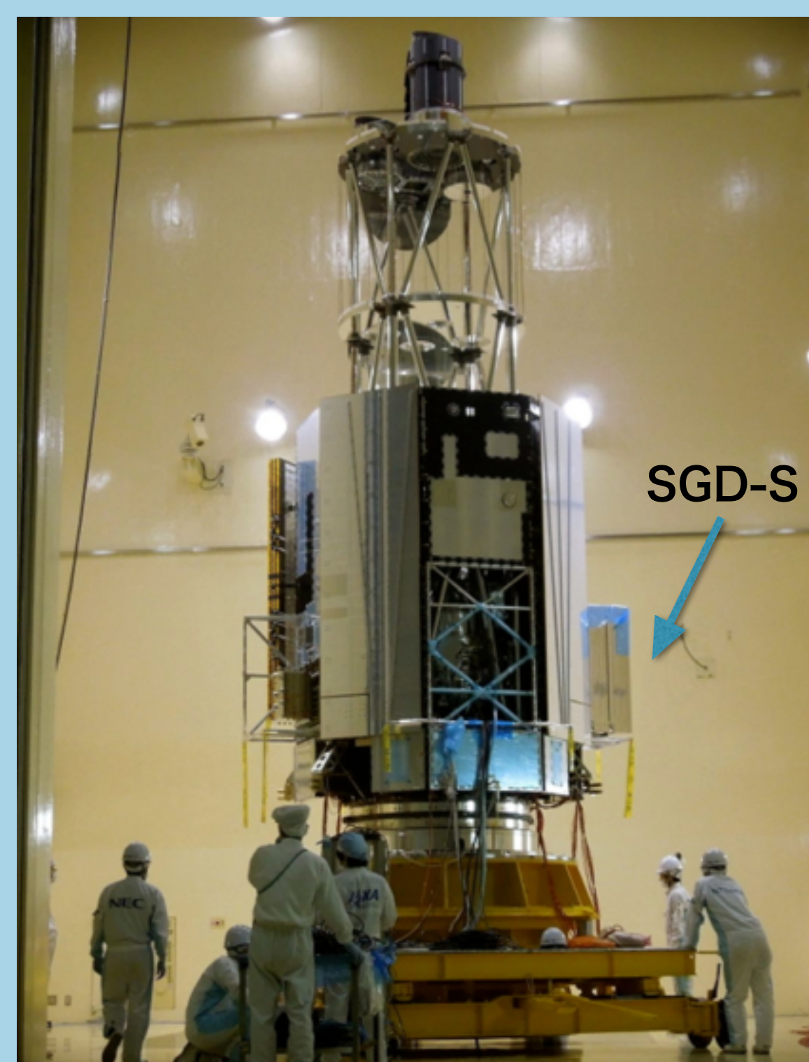
図7 音響試験に向かうASTRO-H衛星MTMとそれにとりつくSGD-Sエンジニアリングモデル。
