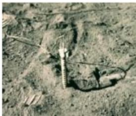
月面に設置された熱流量計 アポロ17号
