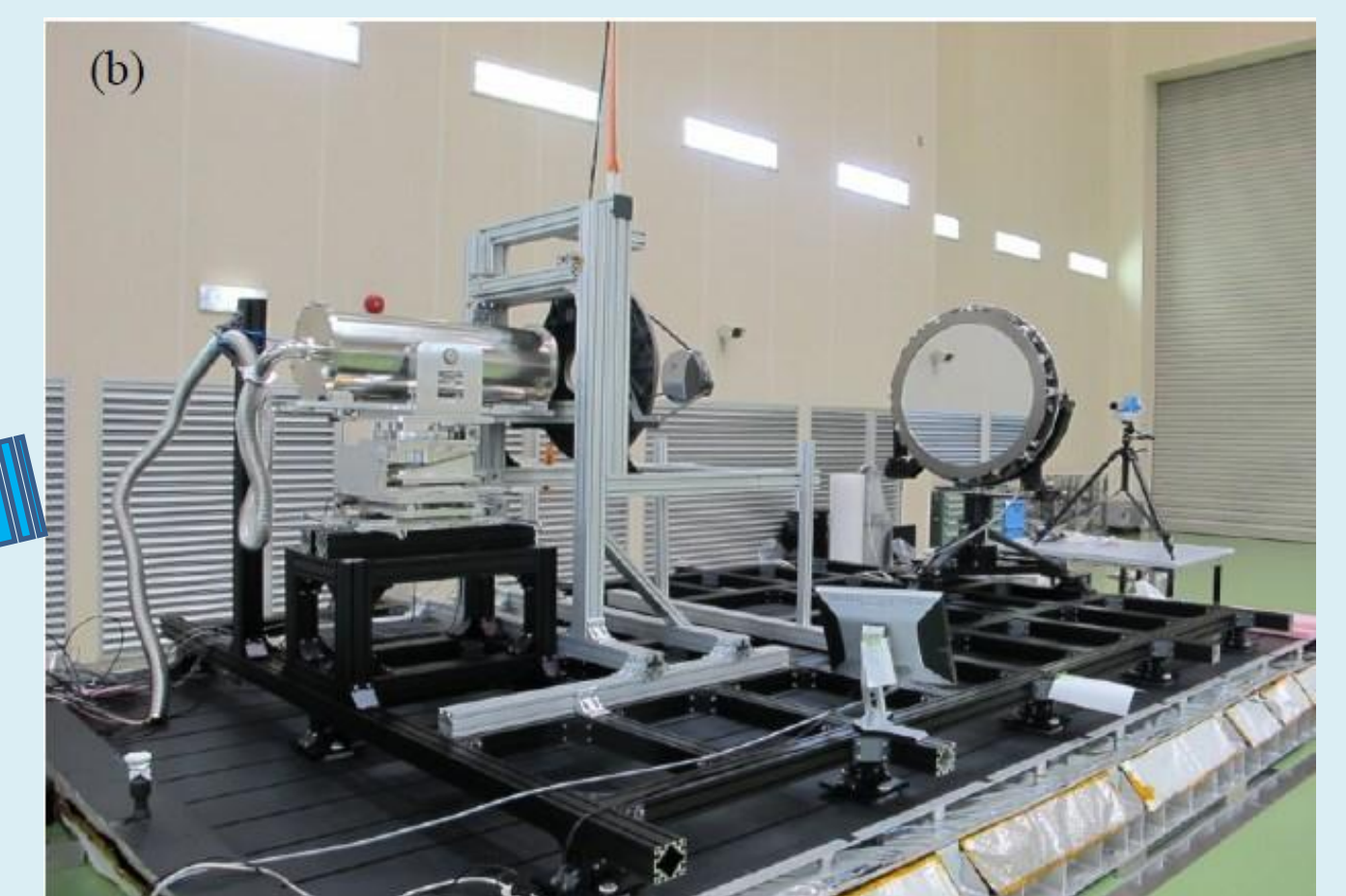
\phi 90 cm平面鏡による全面測定
