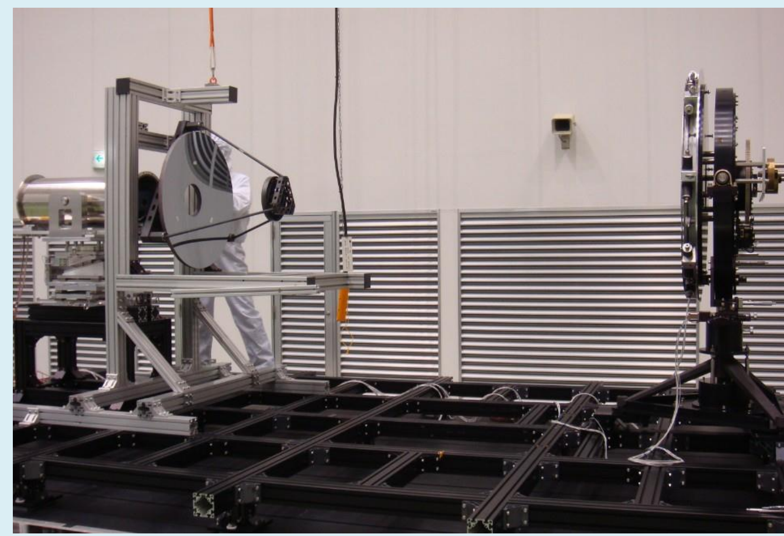
上図: 主鏡と平面鏡の配置 右図: 平面鏡と各位置での測定結果
