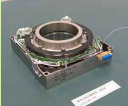
薄肉大口径(3インチ径)の玉軸受を使用し最大Φ68mm開口が可能。新規に設計した中空のDCブラシレスモータでロータ駆動。位置検出用にロータリ光学エンコーダ(黒色のディスク)を搭載。上端のリングはロータに取り付けた回転体ダミー。
