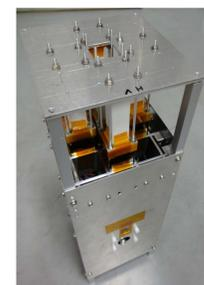
二種類のシンチレータブロック(プラスチック、GSO)と位置検出型光電子増倍管(MAPMT)を組み合わせた偏光計。望遠鏡焦点面に設置。位置分解能は2.3mmで1.3'に相当。(P2-025:定本他参照)
