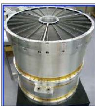
ASTRO-Hの多層膜スーパーミラー(HXT;左図)を焦点距離、直径とも1/2に縮小するデザイン。焦点距離6m。
