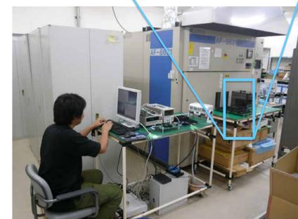
図6: 宇宙用カスタムパッケージ、バーンイン試験用回路基板および試験を行った恒温槽。
