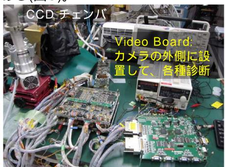
図3: BBM Video・EM Driver による CCD冷却性能試験のセットアップ写真。ここでは Video Board をカメラボディ外に配置し、CCDからの微弱アナログ信号等のモニタを行っている。
