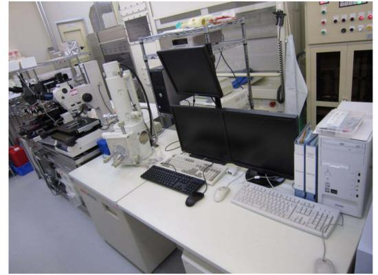
図3 半導体製作プロセス装置(EB描画装置)
