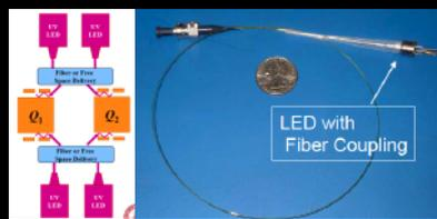
荷電制御: 宇宙線等による試験マスの帯電を除去するために、UV-LEDを用いた荷電制御システムを搭載します。金属表面から叩き出した電子を方向選択的に移動させることによって試験マスの電荷を自由に制御できます。UV-LEDを用いることにより非常にコンパクトで信頼性のあるシステムの構築が可能になりました。GP-B等で実績のあるStanford大学のグループとの共同研究で推進しています。
