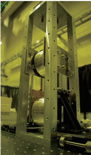
↑ 試験質量と電極板。試験質量は自由粒子を模擬するため振り子で懸架した。下段の金属塊が試験質量に相当する。
