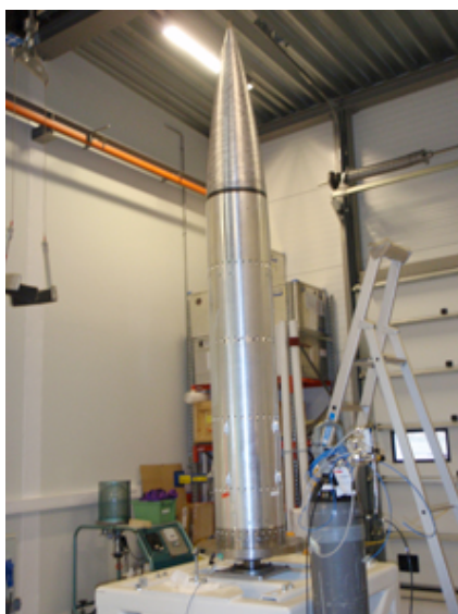
平成26年5月にノルウェーアンドーヤで実施された第3次噛み合わせ試験中のダイナミックバランス試験
