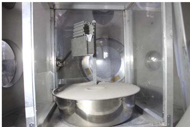
図 2：レーザー変位計とターゲットの位置関係。レーザー変位計はターゲット表面に対して、垂直に設置されている。衝突点からの変位計の前面ガラスまでの距離は約 25.5cm である。
