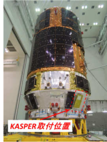
図 2 KASPER 外観 (MLI 艦装前) および KASPER 搭載位置
