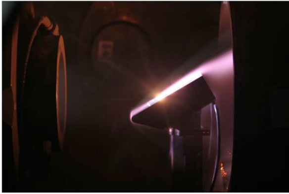
図 6 AWT 加熱試験中のサンプルコレクター周りの斜め衝撃波。
