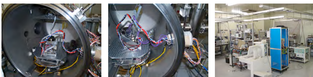
図2-5 LEP-ESAの校正試験の様子。(左) LEP-ESAを回転台の上にセットし、写真の右方向からイオンビームを入射する。(中央) フィラメントを用いた簡易電子源をLEP-ESAの入射口近傍にセットした様子。(右) LEP-ESAの校正試験を行った低エネルギー荷電粒子計測器校正装置の様子。
