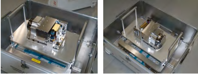
図2-1 製作した伸展機構を含むLEPアナライザー部の写真。
