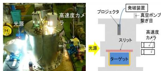
図 3 クレータ形成実験装置
