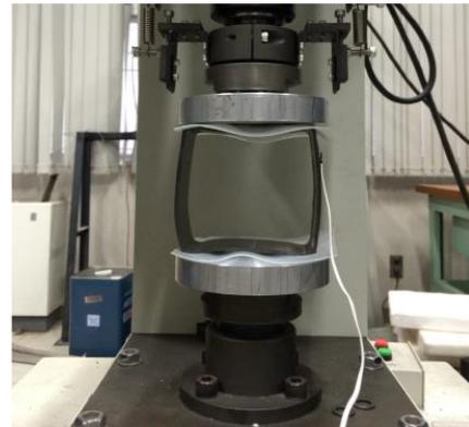
図 2. CFRP 角パイプ個別試験
