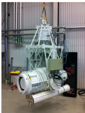
図 5 (左) : PoGOLite の姿勢制御系。差動 GPS、地磁気計、2 台のスタートラッカーから構成される。(右) : フライト中、「かに」星雲を観測している際の 3 時間にわたって測定した Azimuth、Elevation それぞれの指向精度。
