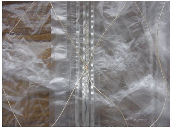
図 8: 網と気球のミシンによる固定。
