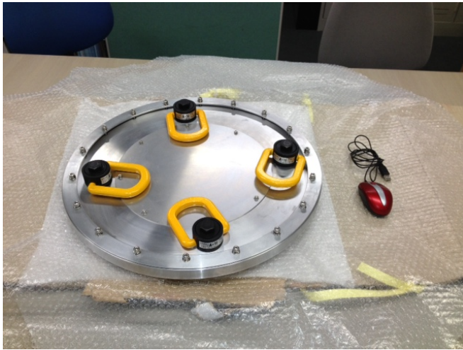
図 7: 1 トン吊り下げ用気球尾部金具。
