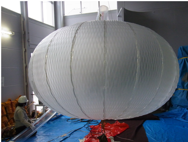
図 1: 常温での 3,000 Pa 印加時の気球。
