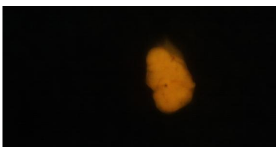
図 3c 岩石の塵の蛍光顕微鏡画像。蛍光顕微鏡のフィルターは WU(励起フィルタ 330nm-385nm、観察波長帯 420nm-)を使用。
