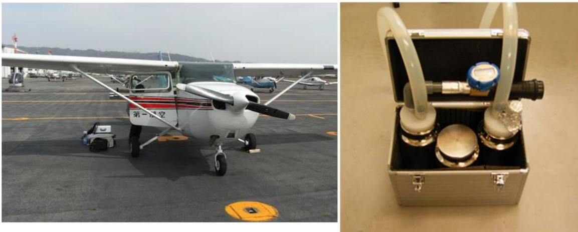
図1. 小型航空機を用いた高度約 1,000 m での黄砂の捕集. 捕集にあたっては、独自に捕集装置を開発した (写真右). 本装置では、水で湿らせた担体の表面に黄砂粒子を吸着させることにより、1 分間に 100 リットルの大気試料を捕集可能である.
