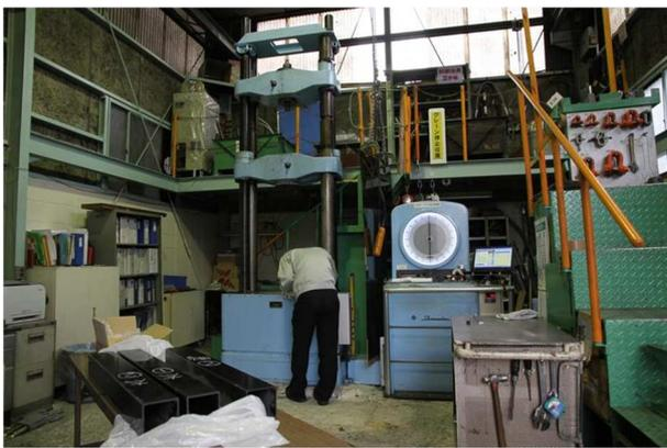
図 2. CFRP 角パイプ座屈試験装置
