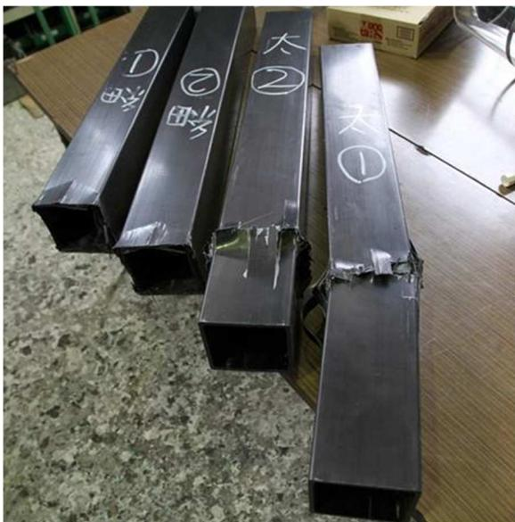
図 3. 圧縮座屈破壊後
