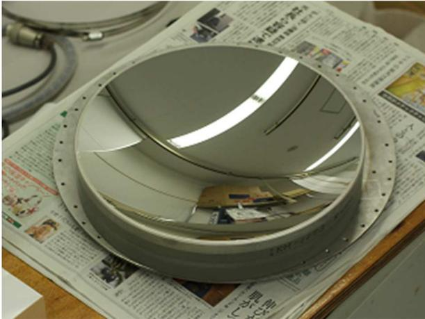
図 8. 300mm 径で F/0.5 の高精度基準球面鏡
