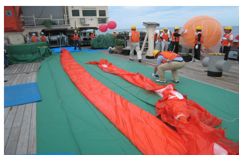
図3：甲板上に展開したB5気球、右後方にヘリウムガスカードルが見える
