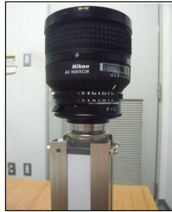
図 2：搭載したスターカメラ
