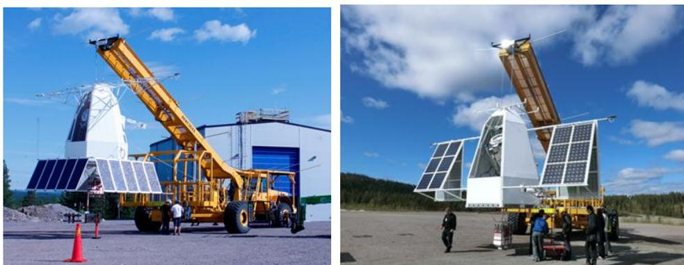
図 3：放球直前の PoGOLite 検出器（左）2011 年（右）2012 年。電力は検出器系で 300 W、ゴンドラなどの姿勢制御系で 200 W であり、これをバッテリーと太陽電池で賄う。
