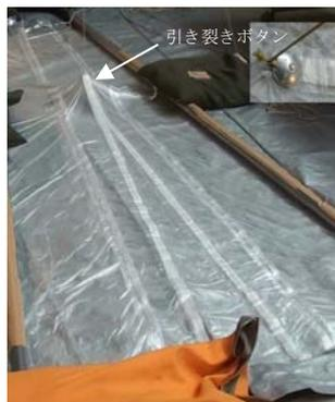
図2 通常型気球の引き裂き装置
