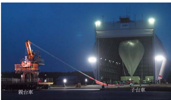
図 1. スライダー式セミダイナミック放球システム
