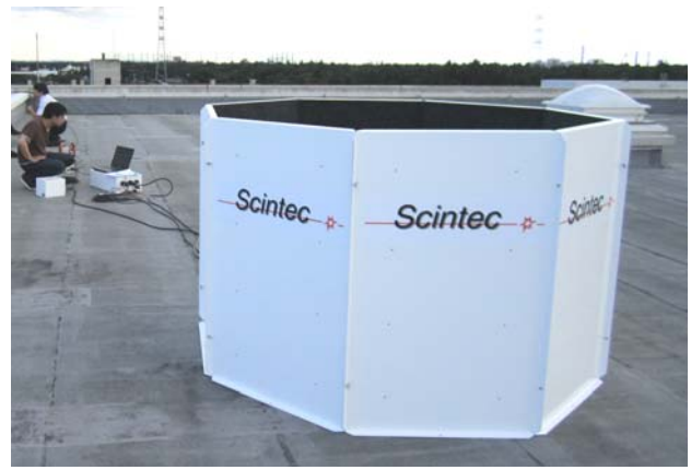
図 6. ISAS で行ったドップラーソーダ風向風速計 (SCINTEC 社製 SFAS64) の試験運転。
