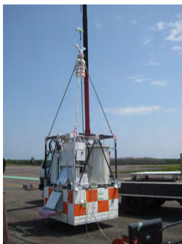
(a) 屋外での方向制御試験中の pGAPS Gondra
