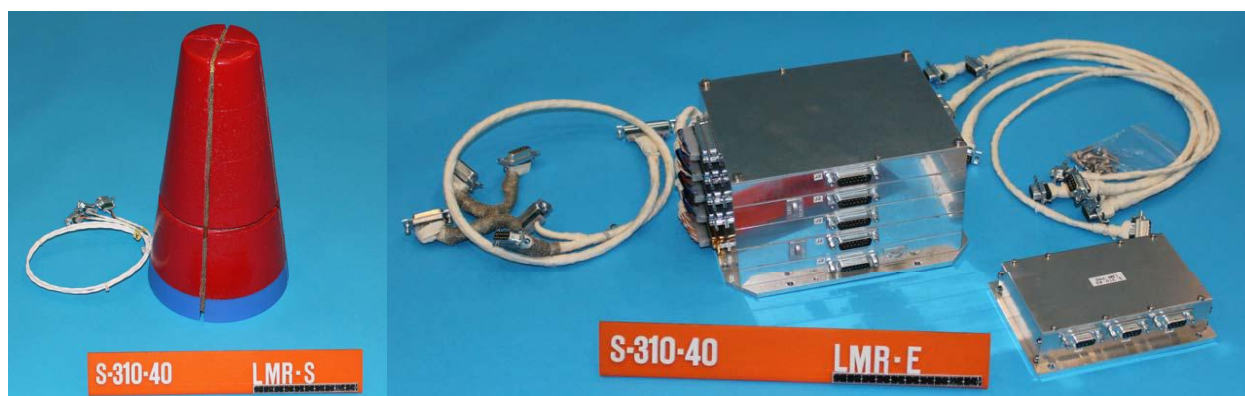
図 2 受信機 (左:ループアンテナ, 中央:メインエレクトロニクス, 右:プリアンプ)
