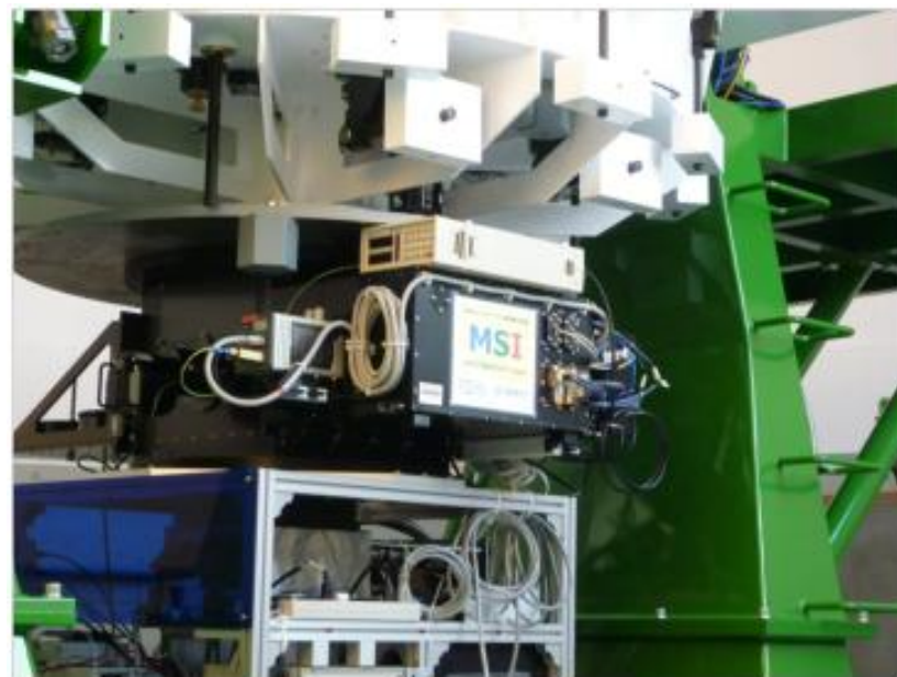
ペリカ望遠鏡のカセグレン 焦点に設置されたMSI
