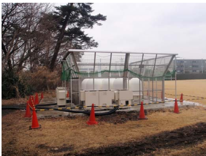
図 3. 次世代ウィンドプロファイラのプロトタイプとして開発された LQ-13
