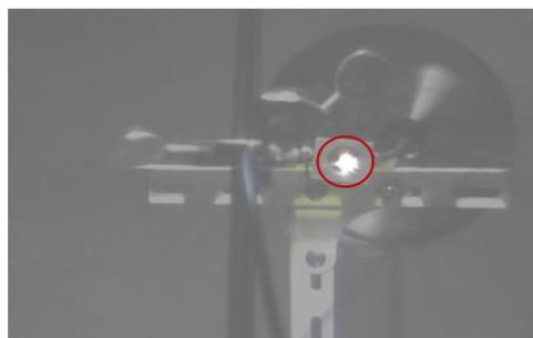
図 7 アンテナでの放電時の発光
