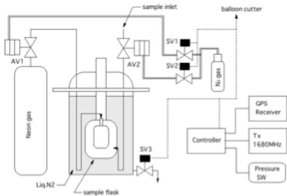
図 1 小型クライオサンプラーの概念図
