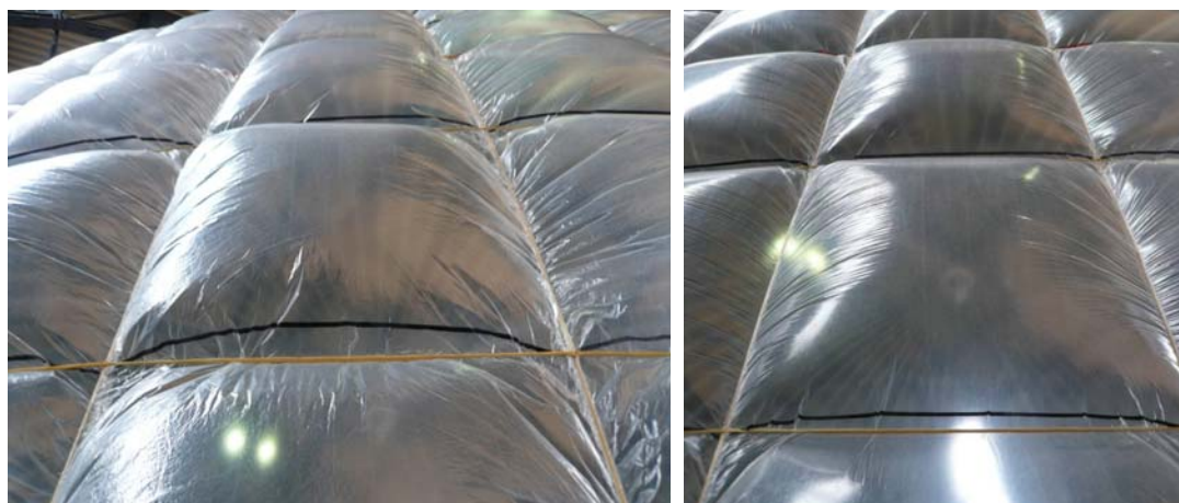
図6 フィルム移動量の変化例(#4-2, 左:0Pa, 右:80Pa)
