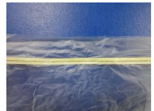
写真4 新しいケブラー帯紐で試作したロードテープ
