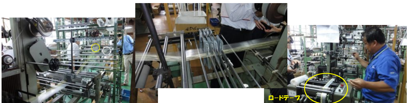
写真5 試作した新しいタイプのロードテープの製作装置
