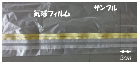
図8 溶着部の強度試験サンプル
