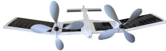
図2. 火星飛行機モックアップ
