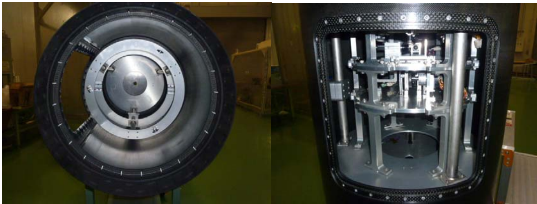
図5 燃焼装置／機体フィットチェックの様子。(左) 機体にリニアスライダー及び燃焼実験装置を収納する“籠”を付けたところ。(右) 燃焼実験装置を“籠”に入れたところ。
