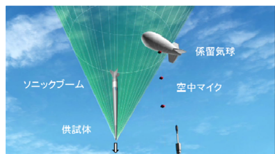
図 10 落下中の供試体と係留気球
