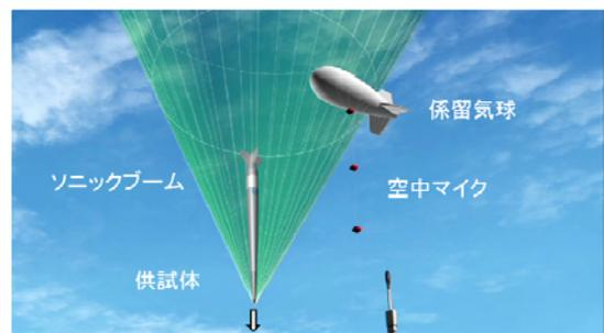
図 10 落下中の供試体と係留気球
